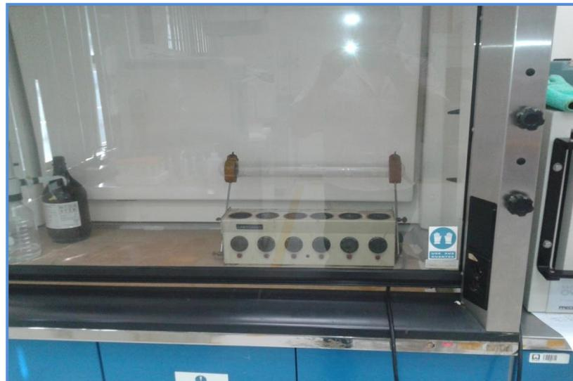
**Figura 3.5** parrilla digestora marca labconco y campana de extracción.
