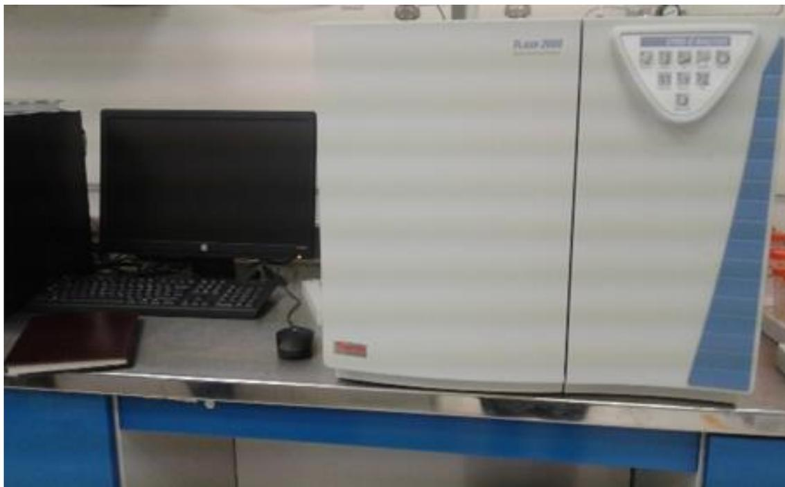
**Figura 3.3.** Equipo FLASH 2000 para la determinación de nitrógeno total
